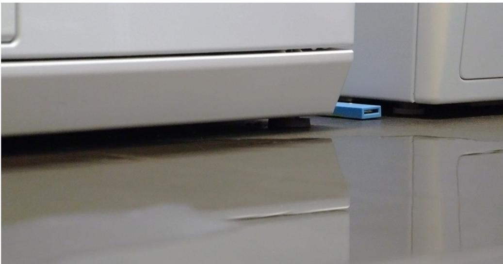
Le capteur d'inondation peut aider à prévenir les catastrophes en fournissant un avertissement précoce de la détection d'eau. Comme la plupart des lave-vaisselles sont déjà équipés de cette fonctionnalité et savent déconnecter l'alimentation en eau en cas de problème, le capteur d'inondation doit être placé dans des zones où des fuites d'eau sont possibles, par exemple sous l'évier de la cuisine, le lavabo de la salle de bain ou proche du lave linge.
